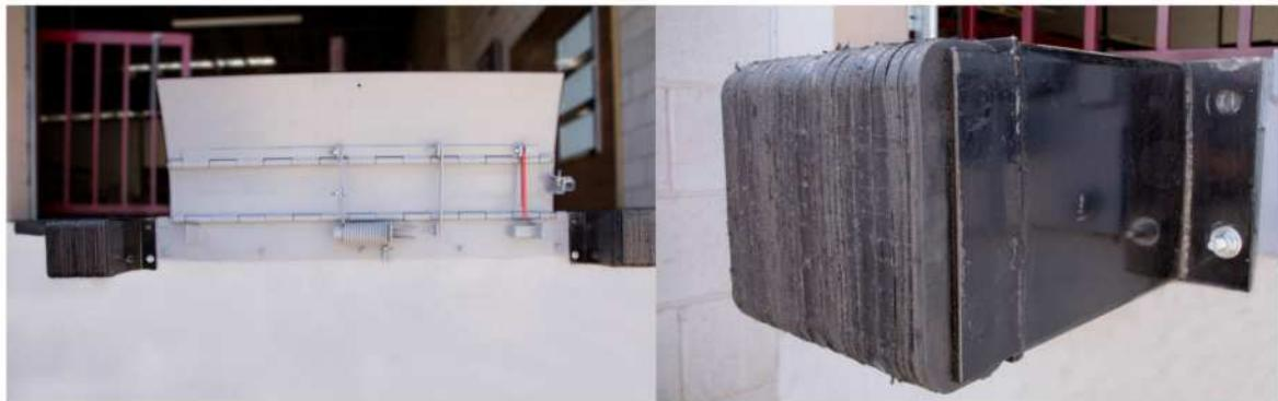
Las rampas de orilla de CHD INDUSTRIAL, están diseñadas para operar de manera fácil y confiable. Un mecanismo de torsión eleva y despliega suavemente la rampa, placas de acero diamantado dan tracción a los equipos de carga, la palanca de operación no se pierde, ya que se guarda en la misma rampa, los topes laminados ofrecen una vida útil más prolongada que los topes moldeados. Al despegar el camión la rampa se guarda automáticamente.
