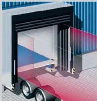
Un shelter inflable abraza la caja de los camiones y tráiler tanto en sus costados como en el toldo, generando el mejor sellado posible de la unidad con el andén de carga, ya que la compresión que generan sus elementos inflables a los contornos de las cajas es extrema. Este proceso permite las siguientes ventajas:
