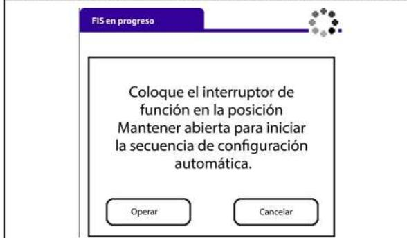
**Paso 9:** Coloque el interruptor de función en la posición Mantener abierta e inmediatamente después vuélvalo a colocar en la posición Cerrada. Puede realizarse la misma función de manera remota desde la Palm al presionar Operar.
