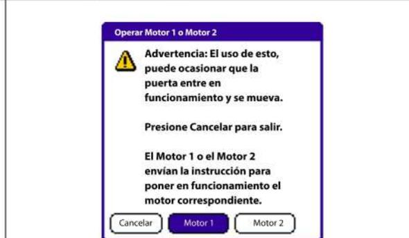
**Paso 10:** Para todas las puertas, *excepto* las puertas de carros, oprima **Motor 1** para poner en funcionamiento la(s) puerta(s) y hacer que se muevan. Para las puertas de carros, oprima **Motor 2** al configurar la segunda puerta.
