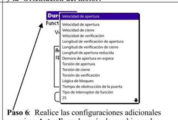
**Paso 6:** Realice las configuraciones adicionales y oprima **Actualizar** después de cambiar cada configuración. Una vez terminadas las configuraciones, oprima **Cancelar** para regresar al menú Selección principal.
